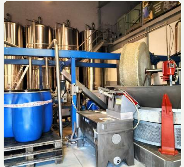
Machines pour concevoir l'huile. A droite la meule pour broyer les olives
